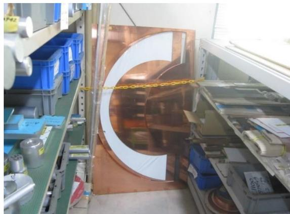
・作業時の安全と地震発生時の転倒防止としてチェーン設置
